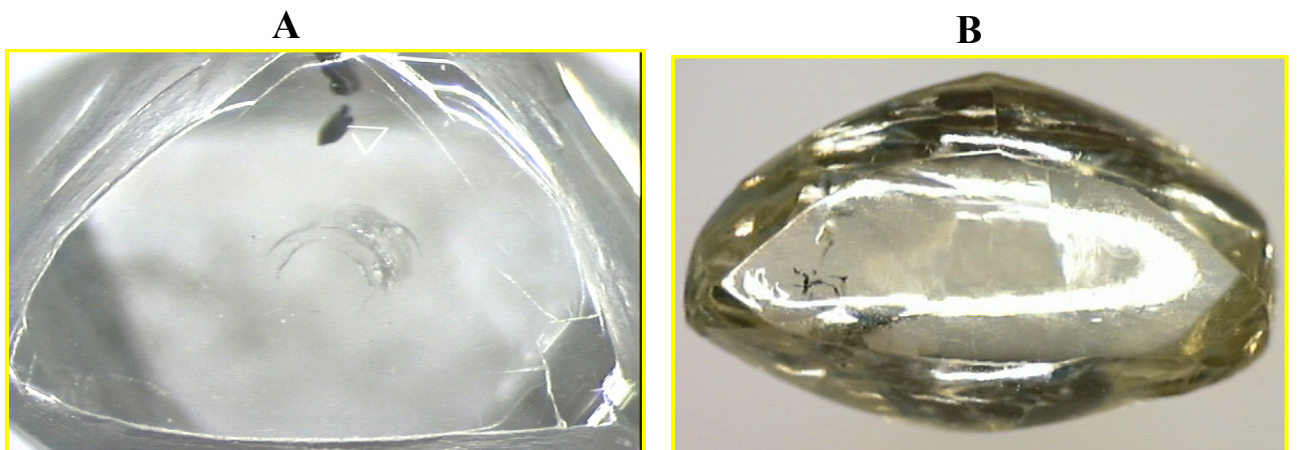
Figura 17 – (A) marca de percussão sofrida por diamante durante transporte. Diamantes depositados em regiões costeiras mostram duas a três vezes mais marcas de percussão que aqueles de depósitos terrestres (Robinson, 1979); (B) polimento ocasionado por transporte longo. Diamantes retidos na malha entre -1,0 mm e +0,710 mm (Fotografias cedidas pela De Beers do Brasil).
