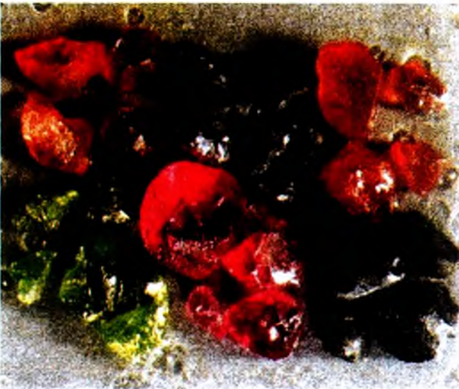
Figura 3 – Minerais pesados/indicadores. Fotomicrografia (25x) de minerais provenientes de tilito, coletados a jusante do kimberlito Point Lake, NWT – Canadá. Observa-se a partir do canto superior esquerdo em grupos de 4: granadas eclogíticas, picroilmenitas, megacristais de granadas eclogíticas, Cr diopsídios, granadas peridotíticas (G10), Ti-Cr cromitas (Fipke et al. 1995).
