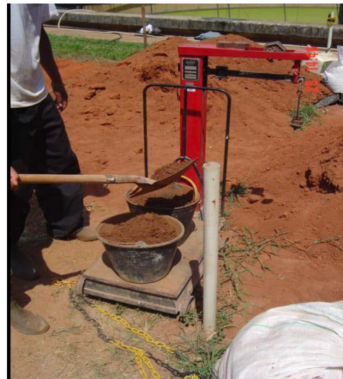
Figura 4.6. Pesagem do solo úmido antes de colocá-lo no tambor.
