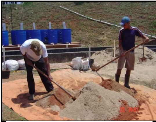
Figura 4.3. Mistura dos solos secos após pesagem.
