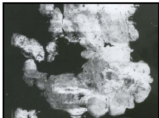
Figura 5.54. Amostra de solo com biofilme – Sistema 3 ( q_h=15\text{cm/d} ).
