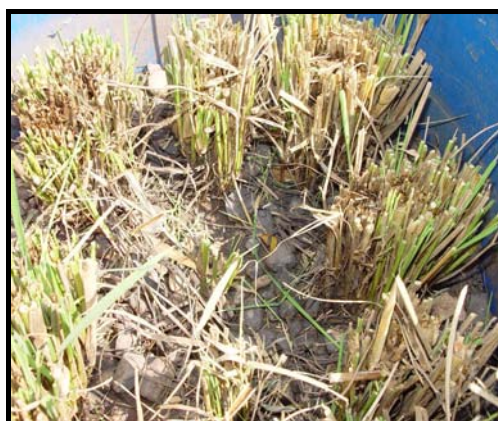
Figura 5.46. Camada superficial do wetland construído - sistema 3 (15cm/d).
