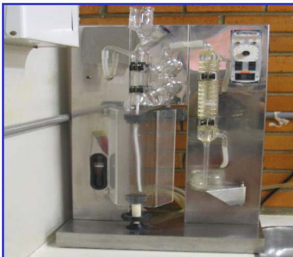
Figura 4.12. Destilador – aparelho utilizado para análise do N total do solo.
