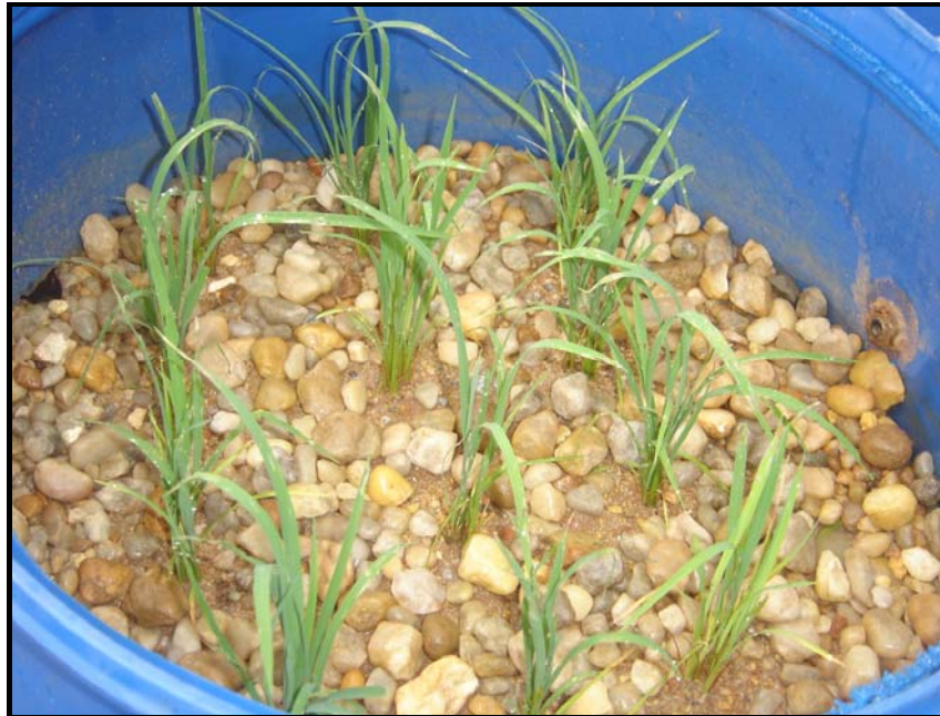
Figura 4.9. Unidade experimental wetland construído após o transplântio da plantas do arroz.
