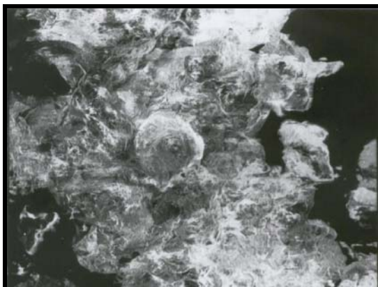
Figura 5.53. Amostra de solo com biofilme - Sistema 2 ( q_h=8\text{cm/d} ).
