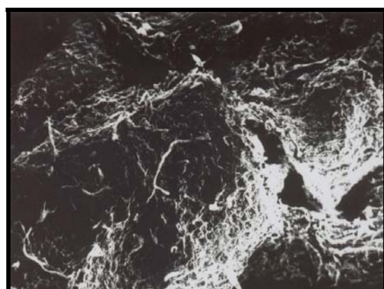
Figura 5.48. Amostra da raiz (pêlos radiculares) com biofilme - Sistema 1 ( q_h=4\text{cm/d} ).
