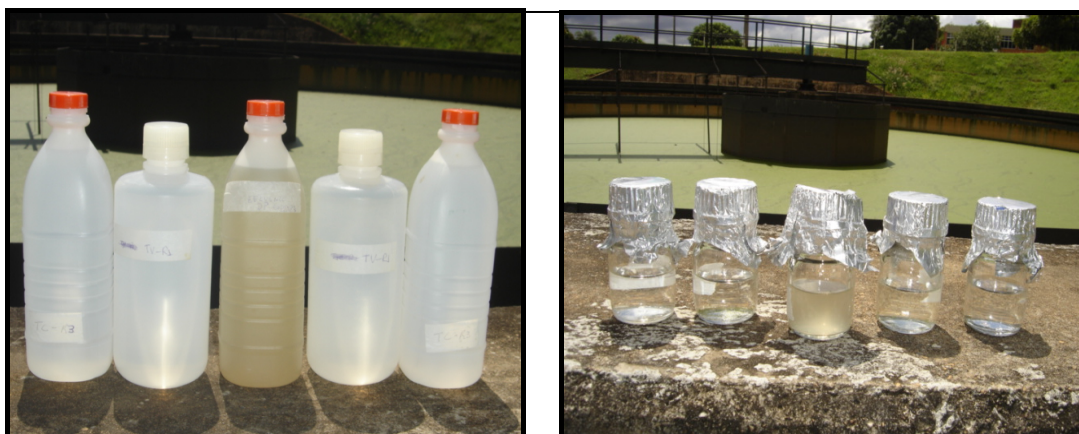
Figura 5.25. Amostras do afluente e dos efluentes produzidos pelas unidades wetlands construídos e controles dos sistemas experimentais.
