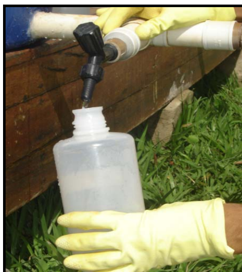
Figura 4.10. Coleta da amostra do efluente tratado.
