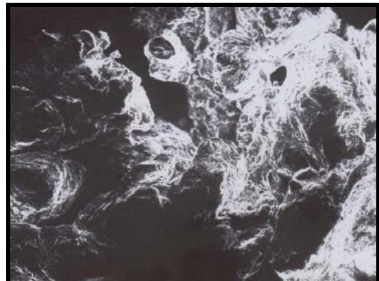
Figura 5.52. Amostra de solo com biofilme - Sistema 1 ( q_h=4\text{cm/d} ).
