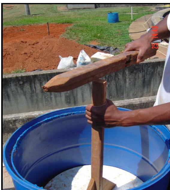
Figura 4.7. Aplicação de uma energia para acomodação do solo.
