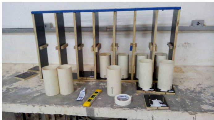
Figura 3.18 – Montagem dos moldes de PVC nas gavetas e apoios inferiores.
