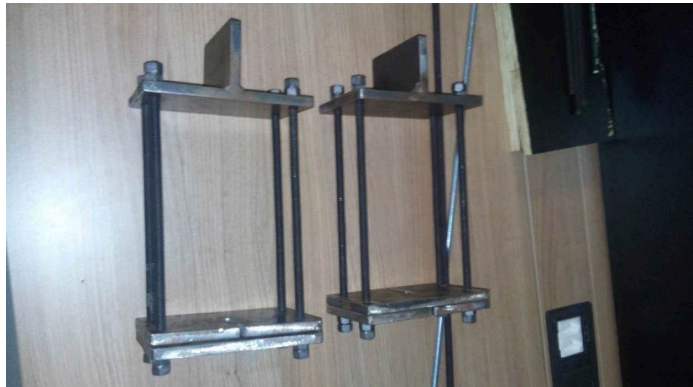
Figura 3.29 – Imagem dos suportes dos corpos de prova na máquina de ensaio de tração pronta.
