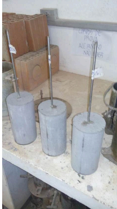
Figura 3.23 – Corpos de Prova para ensaio direto após desmoldados.
