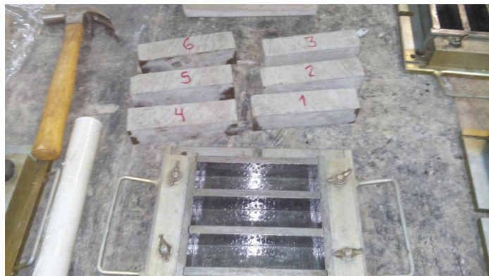
Figura 3.8 – Forma utilizada para fabricação dos Corpos de provas em forma de prismas para ensaio de tração na flexão.
