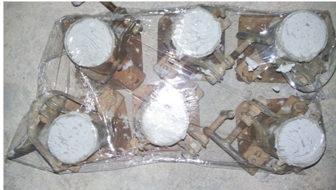
Figura 3.9 – Corpos de Prova Cilíndricos durante cura selada.
