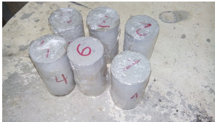
Figura 3.10 – Corpos de Prova Cilíndricos desmoldados e numerados.
