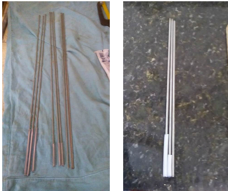
Figura 3.24 – Detalhes das mangueiras utilizadas para limitar aderência na região necessária.
