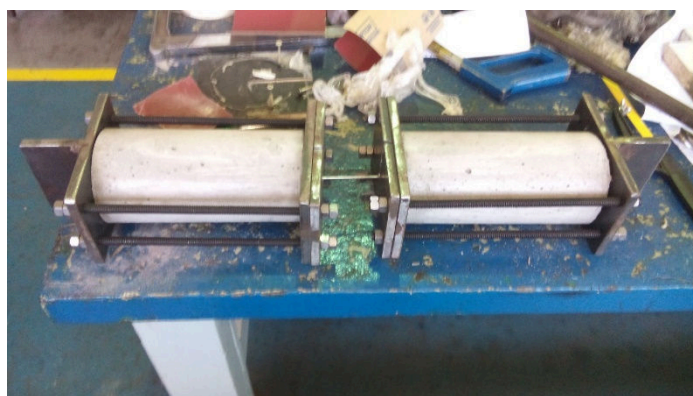
Figura 3.31 – Imagem do corpo de prova montado no suporte para ensaio.
