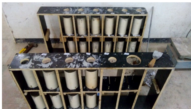
Figura 3.20 – Prateleiras com os Corpos de Prova recém concretados.
