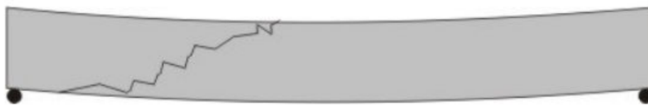
Figura 2.5 – Ruptura do concreto por excesso de tensão no apoio (LEONHARDT E MÖNNIG, 1977).
