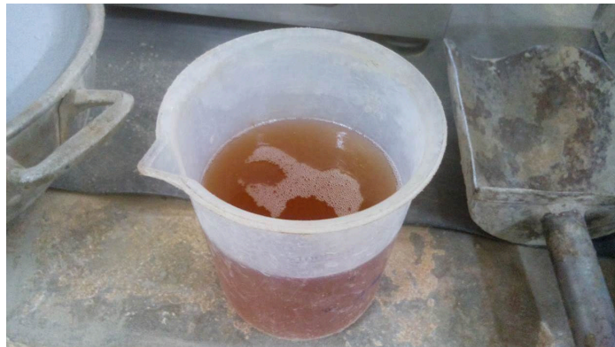
Figura 3.4 – Líquido Plastificante utilizado.
