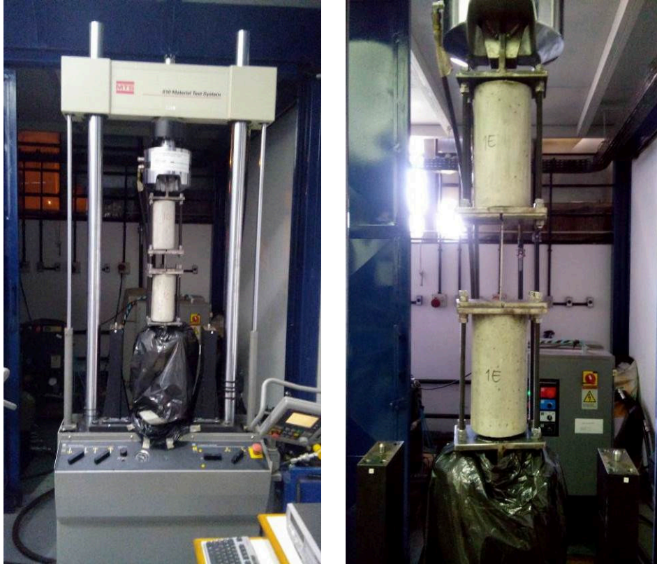
Figura 3.32 – Imagem do corpo de prova montado no suporte e fixado na máquina para ensaio indireto.
