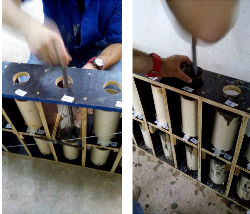
Figura 3.19 – Imagens dos golpes utilizados para homogeneização e preenchimentos dos espaços.
