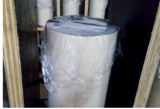
Figura 3.21 – Detalhe do filme utilizado para garantir a cura selada.
