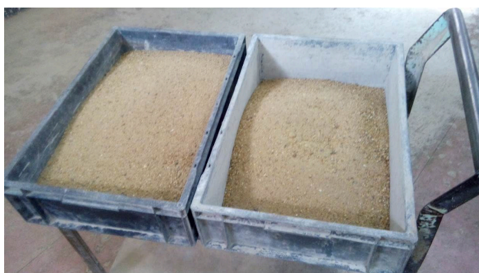
Figura 3.2 – Agregado miúdo (areia) utilizada na mistura.
