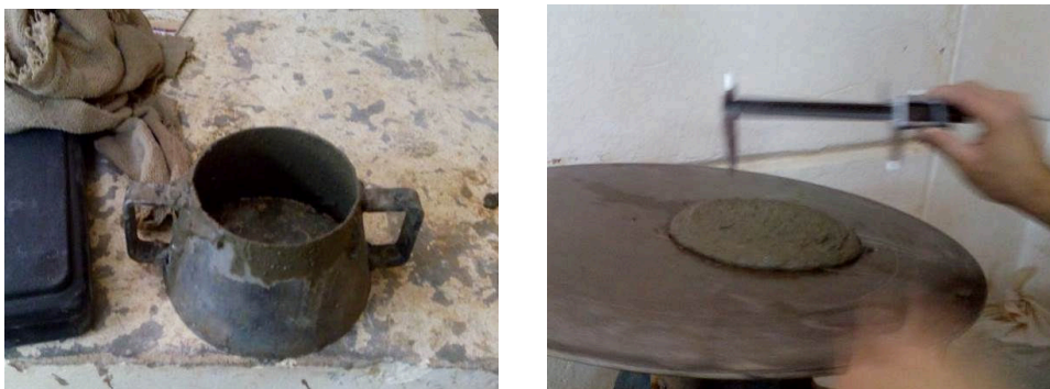
Figura 3.6 – Abatimento de tronco de cone utilizado para medir a trabalhabilidade no microconcreto.
