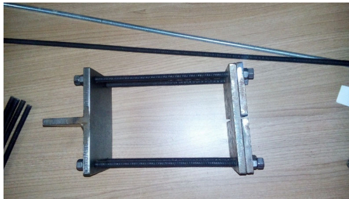
Figura 3.28 – Imagem do suporte do corpo de prova na máquina de ensaio de tração pronta.
