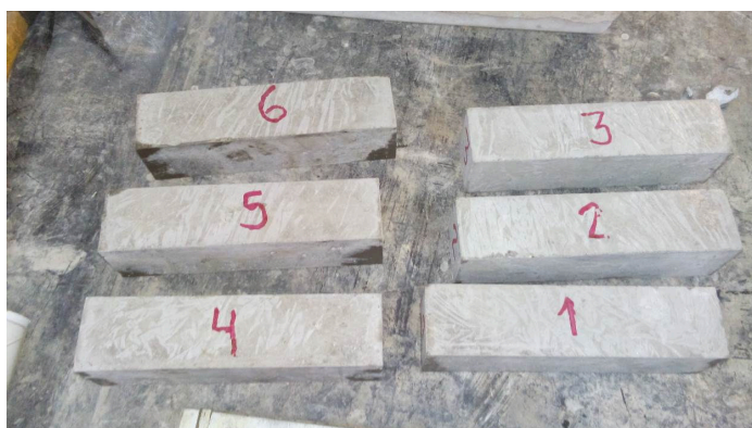
Figura 3.11 – Corpos de provas em formato de prisma inteiros.
