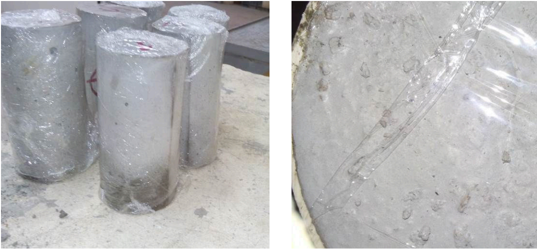
Figura 3.7 – Corpos de prova após desmoldados, 48 horas.
