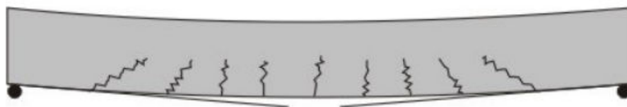
Figura 2.3 – Ruptura do concreto por tração face inferior (LEONHARDT E MÖNNIG, 1977).
