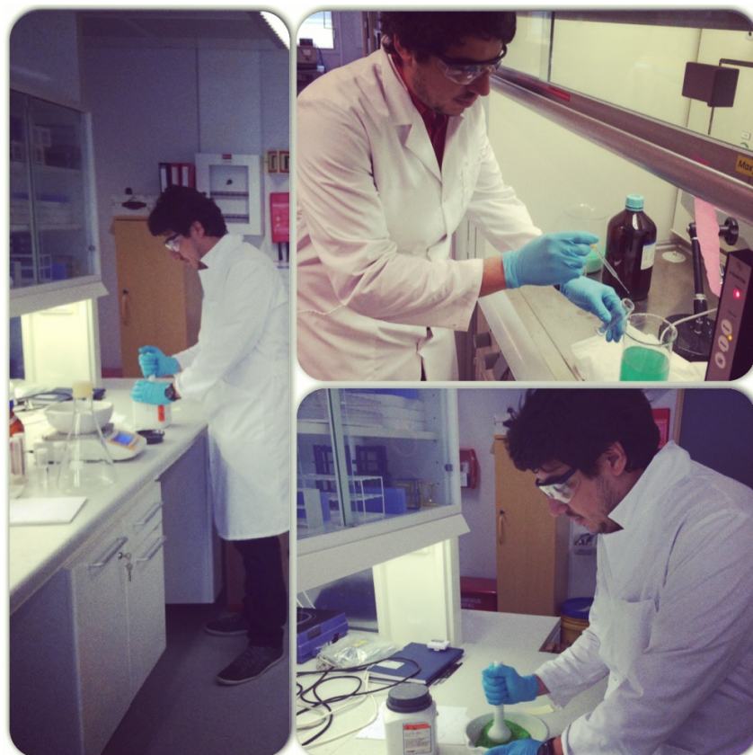
Figura 3.25: Preparação das amostras de Ni-Fluorohectorita a partir da Li-Fluorohectorita através do método de troca catiônica.
