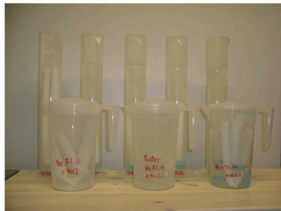
Figura 3.24: Esquema de coluna de diálise utilizada no método ‘tradicional’ de troca catiônica das Fluorohectoritas. Figura obtida da referência [49]
