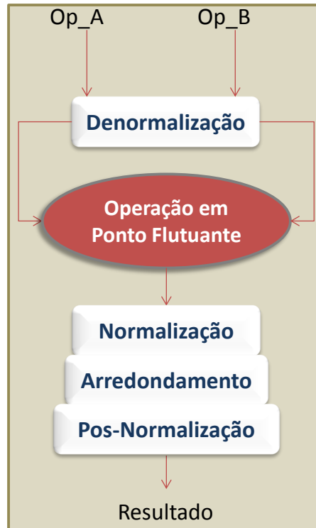
Figura 4.6. Fluxo de dados típico das operações em ponto flutuante
