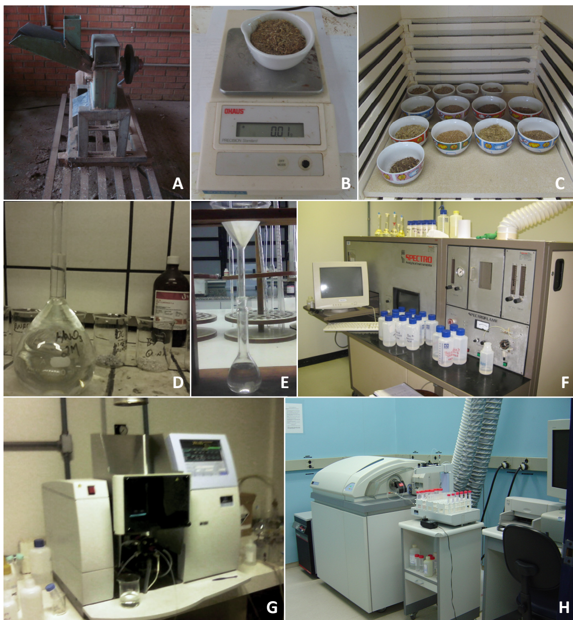
Figura 3.3 - Processos de preparação e análise química das espécies coletadas. A) Moinho de faca; B) Balança de precisão; C) Mufla; D) Adição de HNO 3 ; E) filtragem; F) ICP/AES; G) EAA; H) ICP/MS.
