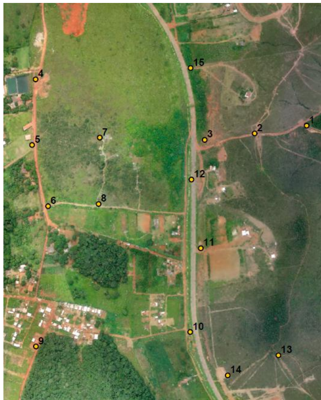
Figura 24 - Área de estudos. Os pontos representados e numerados na figura são pontos de apoio de campo cujas coordenadas foram utilizadas como referência no processamento fotogramétrico e LIDAR.
