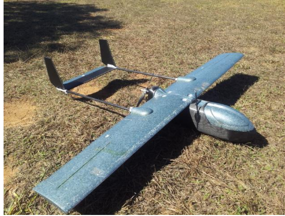
Figura 17 - MicroVANT Graúna utilizado na aquisição de dados fotográficos e de posição.
