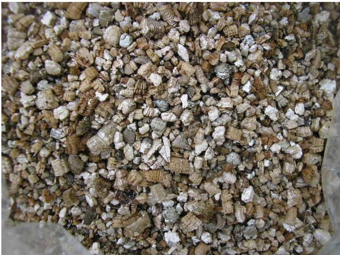
Figura 2.2 – Mineral vermiculita expandido.
