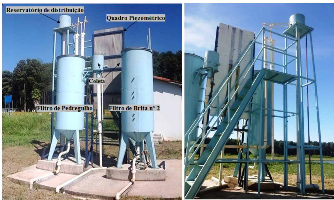
Figura 4.9 – Vistas da instalação piloto. Esquerda: Detalhes dos reservatórios de distribuição e coleta e do quadro piezométrico; Direita: Vista frontal.
