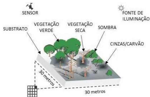
Figura 6. Simulação da mistura de elementos na composição de um mesmo pixel de uma imagem. Adaptado de: ROGAN & FRANKLIN, 2001.
