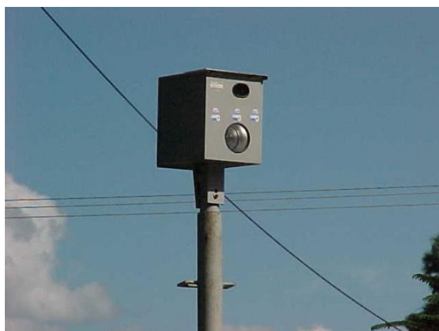
Figura 2.3. Equipamento para fiscalização de avanço de sinal
