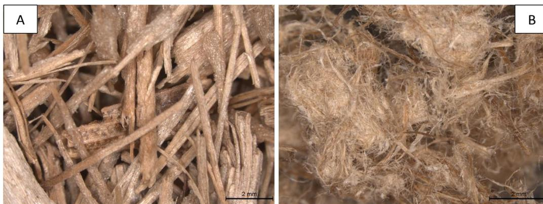
Figura 6.1: A) fibras *in natura* de bagaço; B) fibras celulósicas resultantes após polpação NaOH/AQ.
