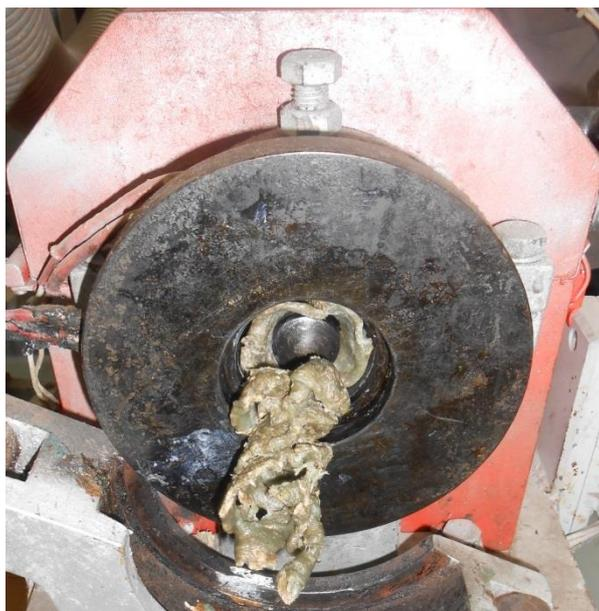
Figura 4.3: Primeira etapa de mistura entre a celulose de bagaço e o PS: mistura em extrusora mono-roscas.
