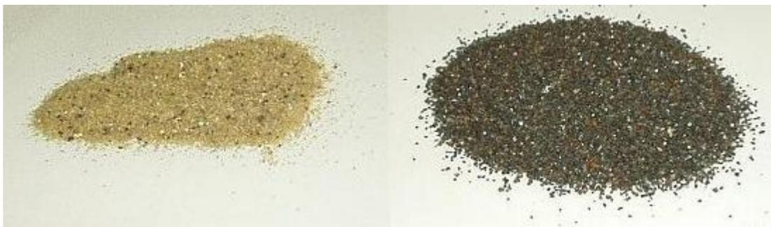
Figura 5.3 - Parcelas de concentrado de sílica e minério de ferro após a separação magnética.
