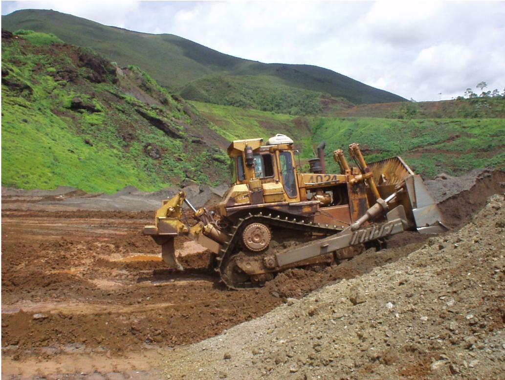
Figura 2.1 - Trator atuando no nivelamento da pilha de estéril na mina de Timbopeba da CVRD.
