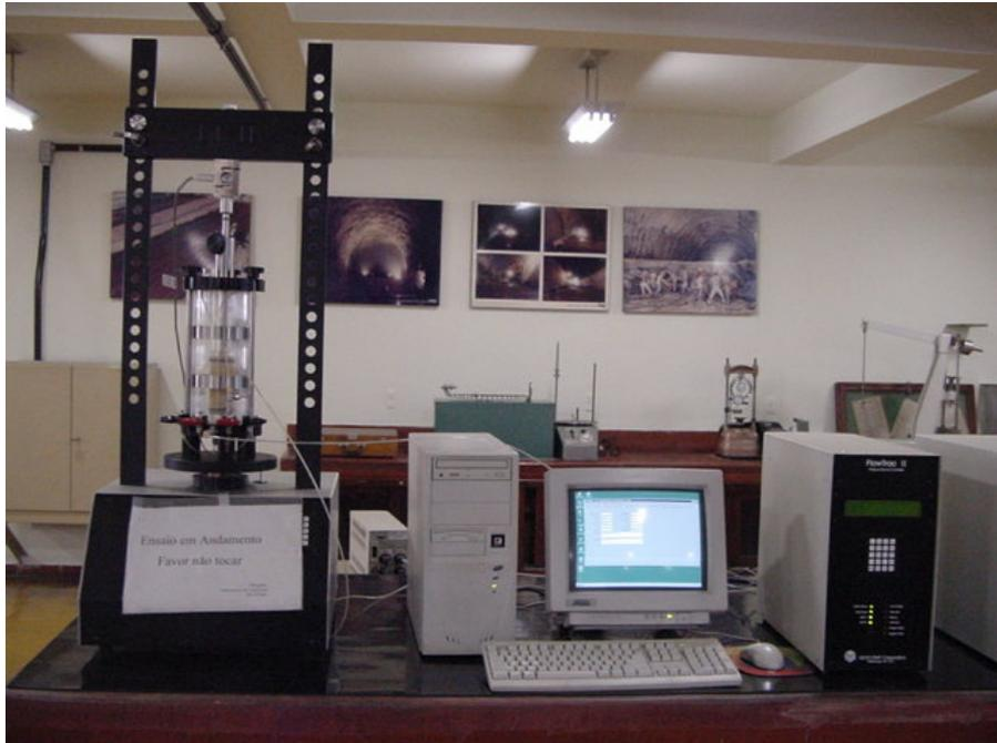
Figura 5.7 - Prensa LoadTrac e as bombas FlowTrac trabalhando em conjunto com um microcomputador.
