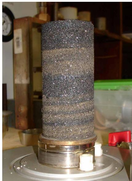
Figura 5.5 - Desbaste lateral do corpo de prova e retirada da amostra do ESDH (modificado, Milonas et al 2006).
