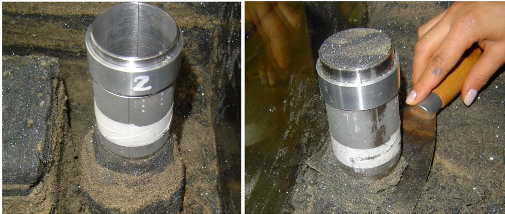
Figura 5.4 - Desbaste lateral do corpo de prova e retirada da amostra do ESDH (modificado - Milonas et al., 2006).
