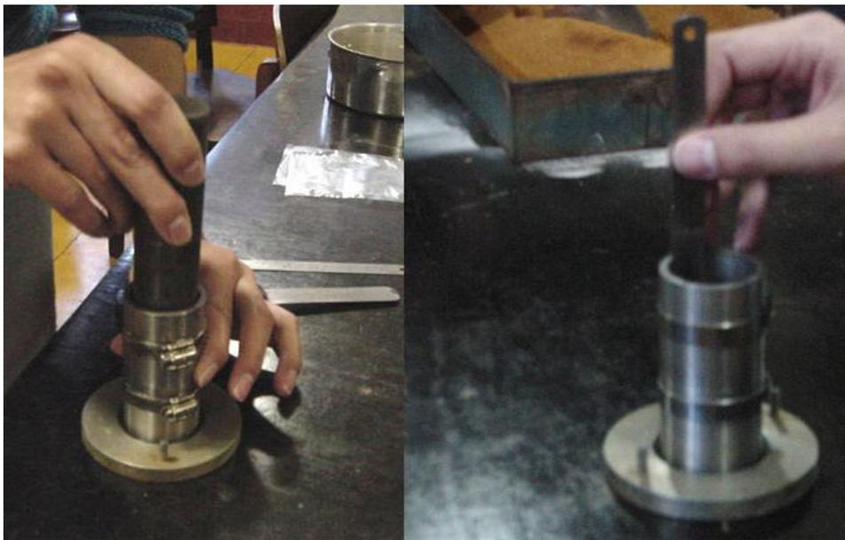
Figura 5.6 - Compactação e verificação da altura da camada com a régua graduada.
