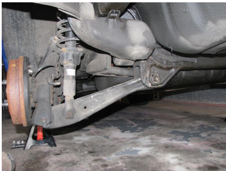
Figura 56 - Foto da suspensão traseira do Honda Civic do sexta geração, onde é possível visualizar o braço inferior traseiro ao centro
