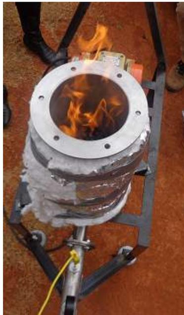
Figura A.11 – Reator operando como combustor.
