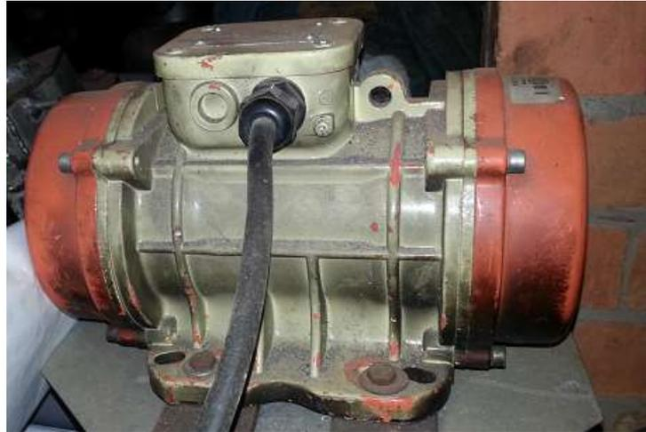
Figura A.5 – Moto vibrador.
