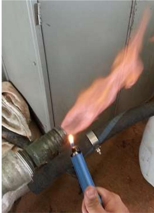
Figura A.13 – Teste de chama do gás de saída do reator
