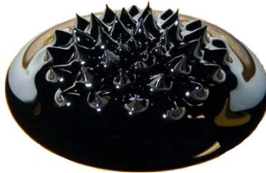
Figura 2: Formação de picos em um nanocolóide magnético, em razão da aplicação de um campo magnético externo [7].
