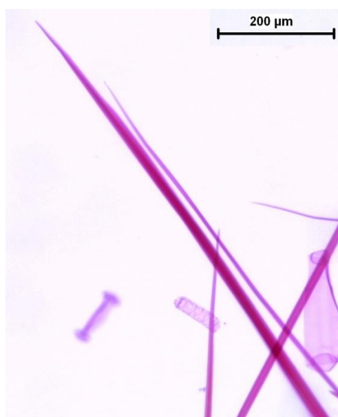
Figura 14– Detalhe de uma fibra espessa e uma fibra mais fina e algumas células de elemento de vaso de um colmo de Brazlândia. Foto: Eduarda Prates.
