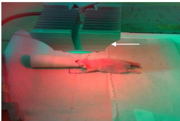
Figura 6: Montagem para aplicação da TFD em camundongos nude com LED como fonte luminosa. Irradiação tumoral de maneira perpendicular em carcinoma espinocelular tratado com óleo de açaí nanoemulsionado. Os olhos do animal foram protegidos da luz. Seta indicando o LED com irradiação perpendicular
