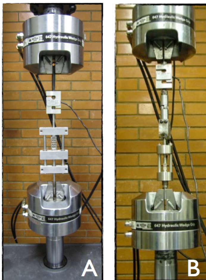
Figura 5 - Dispositivos de testes montados na máquina de ensaios MTS. A – Dispositivo Flextest montado na MTS. B – Dispositivo Bencor Multi-T montado na MTS.
