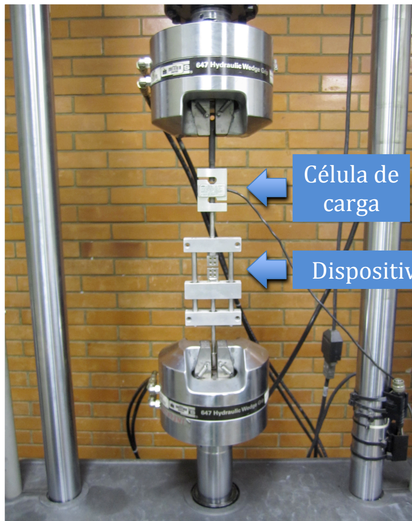
Figura 1 - Máquina de ensaios MTS com o dispositivo Flextest e célula de carga acoplados para realização dos ensaios de resistência adesiva à microtração.
