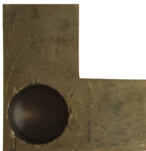
Figura 10 - Aparato de latão para fixação dos dentes à mesa auxiliar da máquina de cortes.
