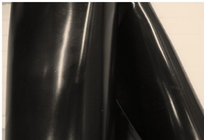
Figura 3.9. Geomembrana lisa de PVC utilizada nos ensaios.
