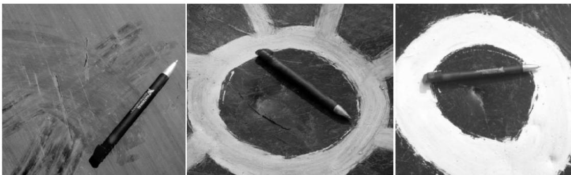
Figura 2.6. Danos mecânicos em geomembranas: rasgos, cortes e puncionamentos (Rebelo 2008)
