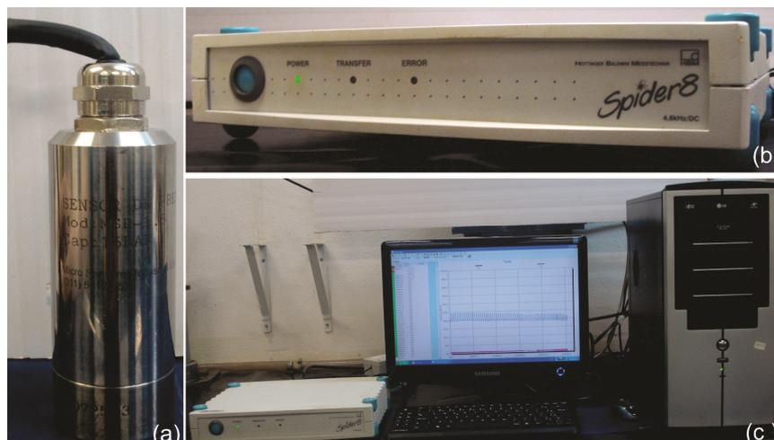
Figura 3.7. Sistema de aquisição de dados: (a) Transdutor de pressão, (b) aquisitor de dados Spider 8 e (c) sistema de aquisição de dados.
