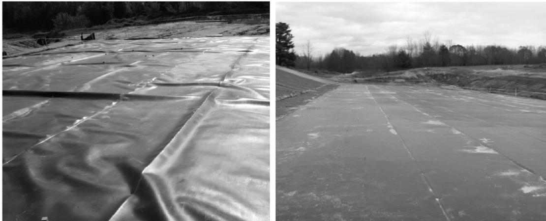
Figura 2.14. Rugas interconectadas numa geomembrana (esq.) e geomembrana essencialmente sem rugas (dir.) (Rowe & Hosney, 2010).
