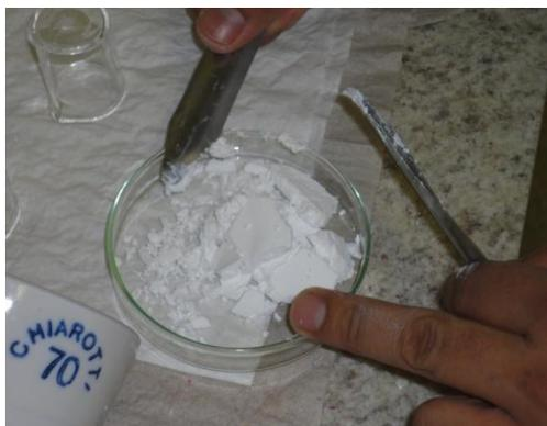
**Figura 9:** Citrato de estanho após o processo de filtração.
