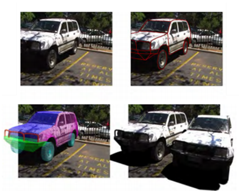
Figura 2.31: A imagem mostra: um quadro de vídeo sequência, o traçado parcial do modelo, o modelo final sobreposto ao vídeo, e o resultado de renderização do modelo final de volta na sequência original [27].
