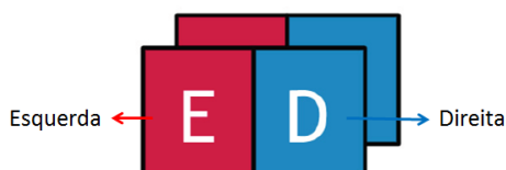
Figura 2.11: Na exibição de 3D lado-a-lado cada quadro contém a representação da imagem para o olho esquerdo e direito © 8 .
