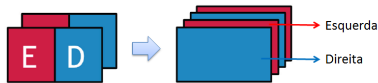
Figura 2.12: Conversão de 3D lado-a-lado para sequencial © 8 .
