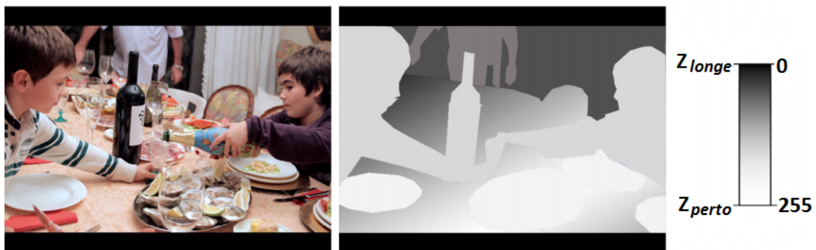
Figura 2.20: Codificação de uma imagem: 2D plus Depth Map [21].
