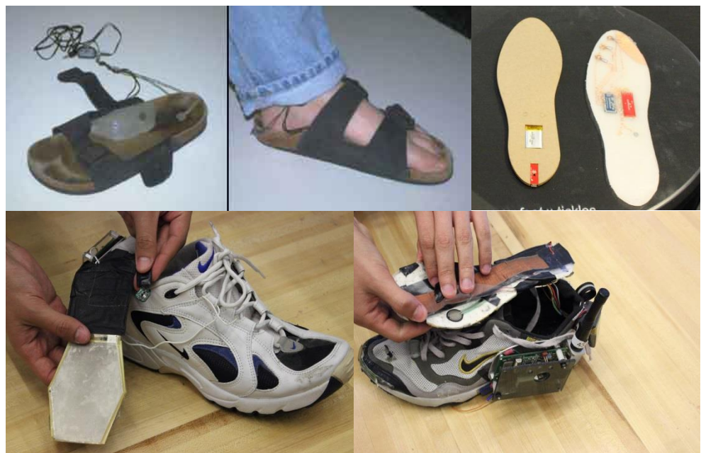
Figura 69 – Projetos do MIT-Media Lab. Acima: a) sandália com sensor GSR ( GSR Shoes ), do grupo Affective Computing (Picard e Healey, 1997); b) palmilha com GPS para indicar localização de Dhairya Dand, do grupo Information Ecology . E Abaixo c): tênis do grupo Responsive Environments com sistema para gerar energia com base na pisada da pessoa, e com sensores de pressão. Fotos do GSR Shoes por Fernando Padilla e disponível em: http://affect.media.mit.edu/projectpages/archived/projects/affective_jewelry.html Fotos da palmilha e tênis: Mirella Altoé e Tiago Lucena.
