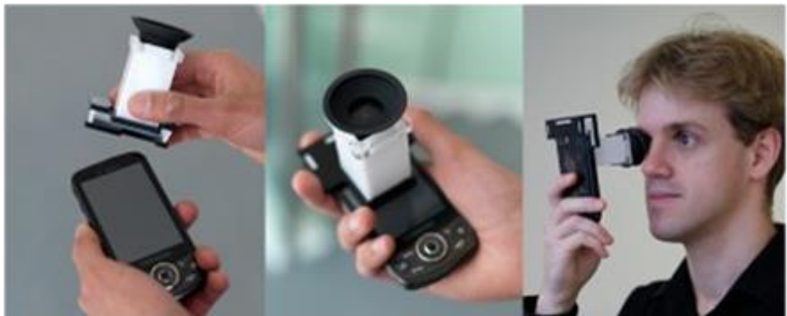
Figura 66 - Chamado Netra (Near-Eye Tool for Refractive Assessment) , o aparelho usa um sistema óptico derivado de códigos de barra, produzido em 2011 por alguns membros da equipe do grupo Camera Culture MIT . Na foto: Victor Pamplona (doutorando).
