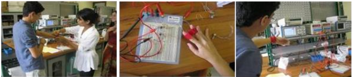
Figura 90- Etapa laboratorial de criação de sensores biológicos. Em teste, sensor GSR ( Galvanic Skin Response ) usado posteriormente em diversas exposições e projetos de arte do grupo.
