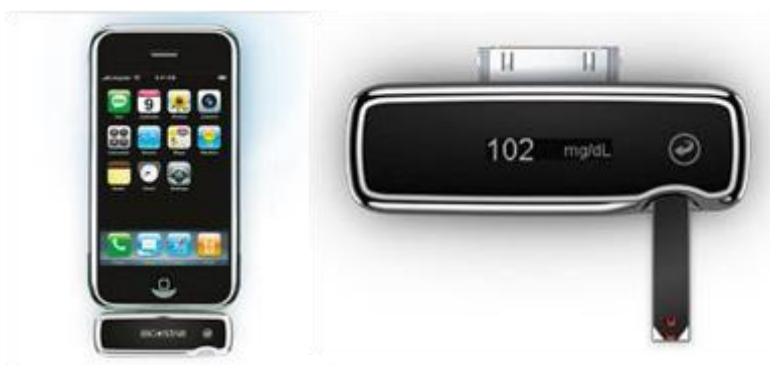
Figura 65 - Dispositivo que realiza exame de glicose para ser acoplado aos i-phones .
