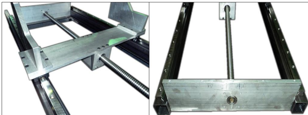
Figura C.25: Base do Portal
