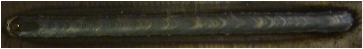
Figura 5.16: Cordão final obtido depois do controle para uma largura de 6mm com arame maciço.
