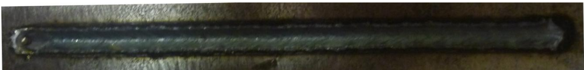
Figura 5.10: Cordão final obtido depois do controle para uma largura de 5mm com arame maciço.
