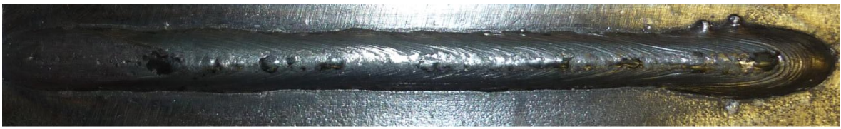
Figura 5.34: Cordão final obtido depois do controle para uma largura de 7 mm com arame tubular.
