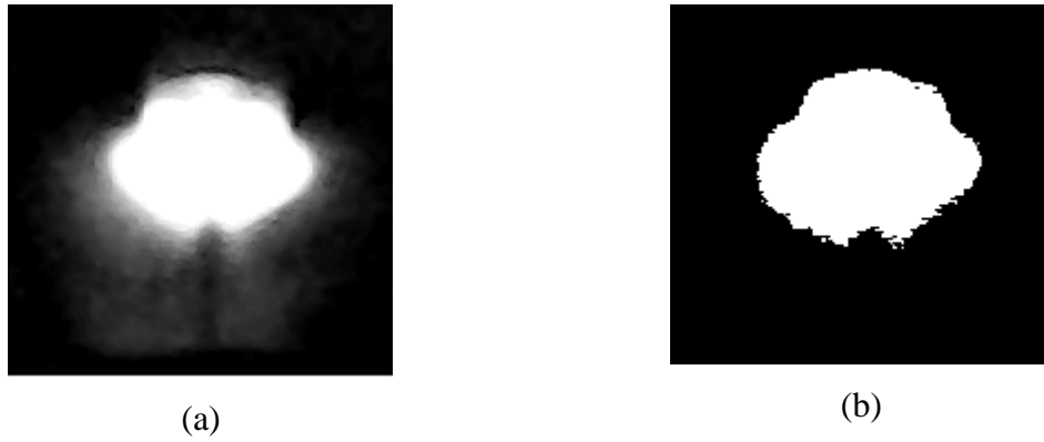
Figura 4.10: (a) Imagem escala de cinzas e filtro de mediana, (b) Imagem Binarizada.
