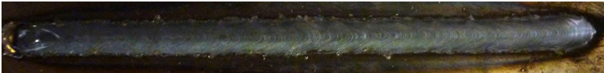
Figura 5.22: Cordão final obtido depois do controle para uma largura de 7 mm com arame maciço.
