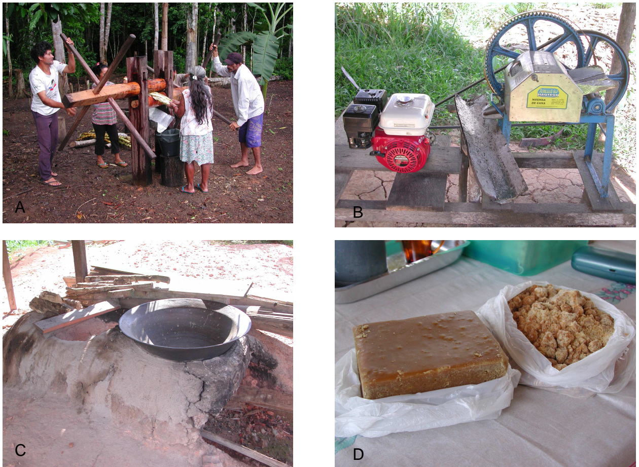
Figura 9 – Algumas técnicas de preparo dos derivados da cana-de-açúcar A. Moenda de cana artesanal; B. Moenda de cana industrial; C. Forno e chapa de ferro; D. Rapadura e gramixó.
