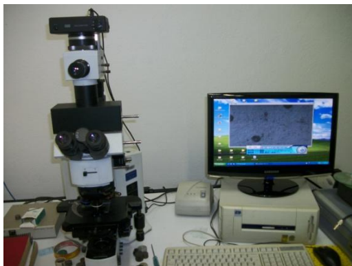
Figura 3.5. – Microscópio óptico Olympus BX51 e máquina Sony SSC-DC50A.
