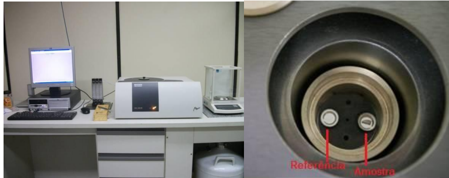
Figura 3.10. Calorimetro DSC Netzsch 200 F3 Maia e cadinhos de alumínio usados no ensaio.
