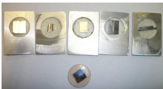
Figura 3.9. - Amostras cortadas longitudinalmente e embutidas em uma chapa de alumínio para ensaio de Raios X.
