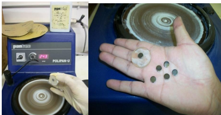
Figura 3.4 – Amostras polidas em feltro com abrasivo de suspensão de alumina para acabamento espelhado.
