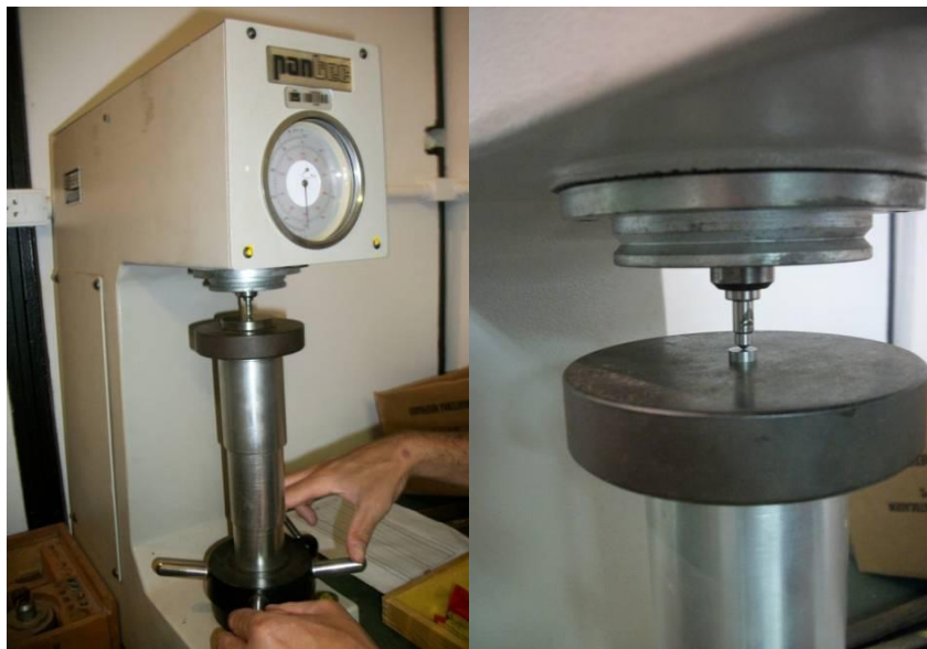
Figura 3.12 – Ensaio de dureza feito com o durômetro modelo Rain-Rs Panambra .
