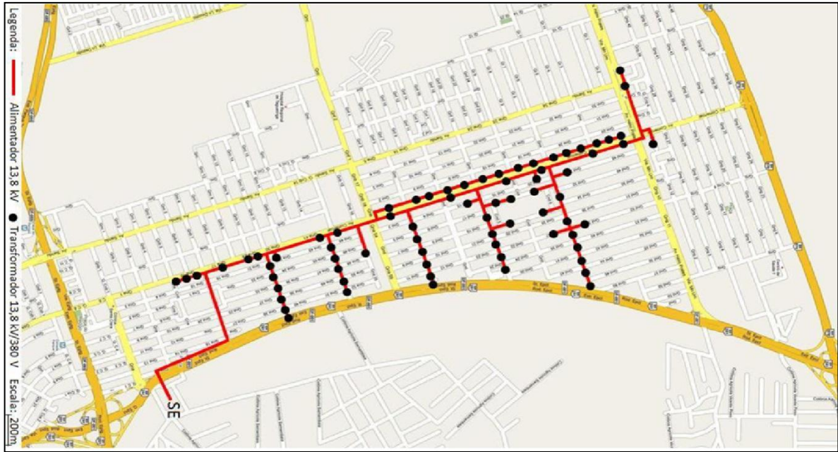
Figura 3.6 – Percurso do alimentador TG01 - topologia radial com ramificações.
