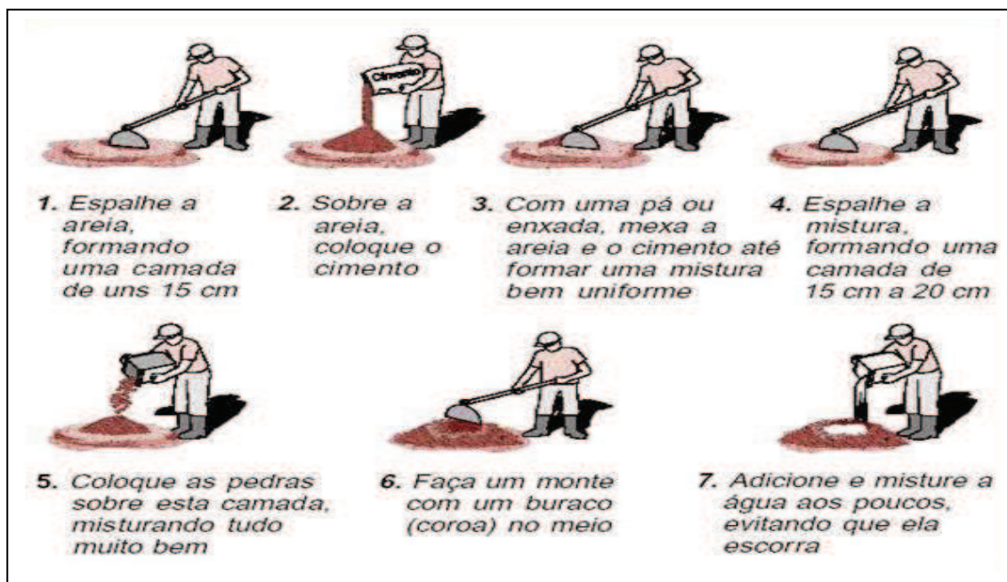
Figura 06: como preparar um bom concreto (Fonte: cimento.org).
