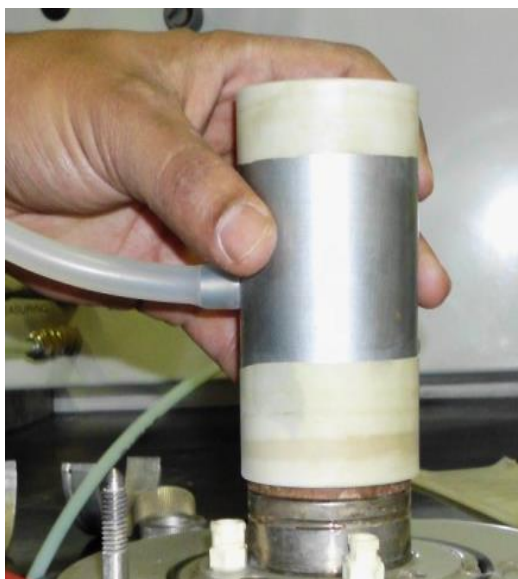
Figura 3.14. Colocação dos o-rings e da membrana de látex no corpo de prova
