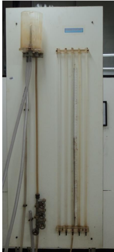
Figura 3.6. Permeômetro, equipamento utilizado para a realização do ensaio de permeabilidade a carga constante
