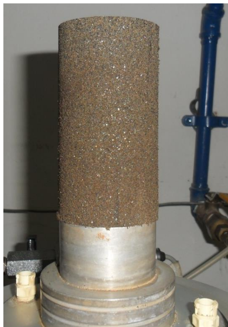
Figura 3.13. Detalhe do corpo de prova para a realização dos ensaios de permeabilidade no equipamento triaxial.
