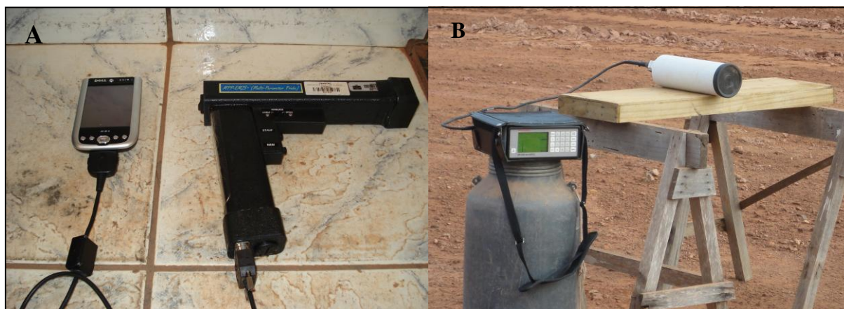
Figura I.5: (A) Equipamento MPP-EM2S+ ( Multi Parameter Probe ) desenvolvido pela GDD INSTRUMENTATION INC utilizado para aquisição dos dados de susceptibilidade magnética e condutividade; (B) Equipamento Gamaespectrômetro GR-320, fabricado pela Exploranium utilizado para aquisição dos dados radiométricos.
