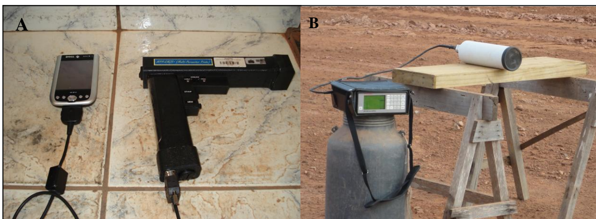
Figura 3.3: (A) Equipamento MPP-EM2S+ ( Multi Parameter Probe ) desenvolvido pela GDD INSTRUMENTATION INC utilizado para aquisição dos dados de susceptibilidade magnética e condutividade elétrica; (B) Equipamento Gamaespectrômetro GR-320, fabricado pela Exploranium utilizado para aquisição dos dados radiométricos.
