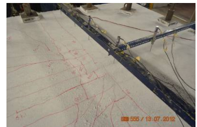
b.3) Nível de carga: 0.81 \cdot P_u (primeiras fissuras radiais)
