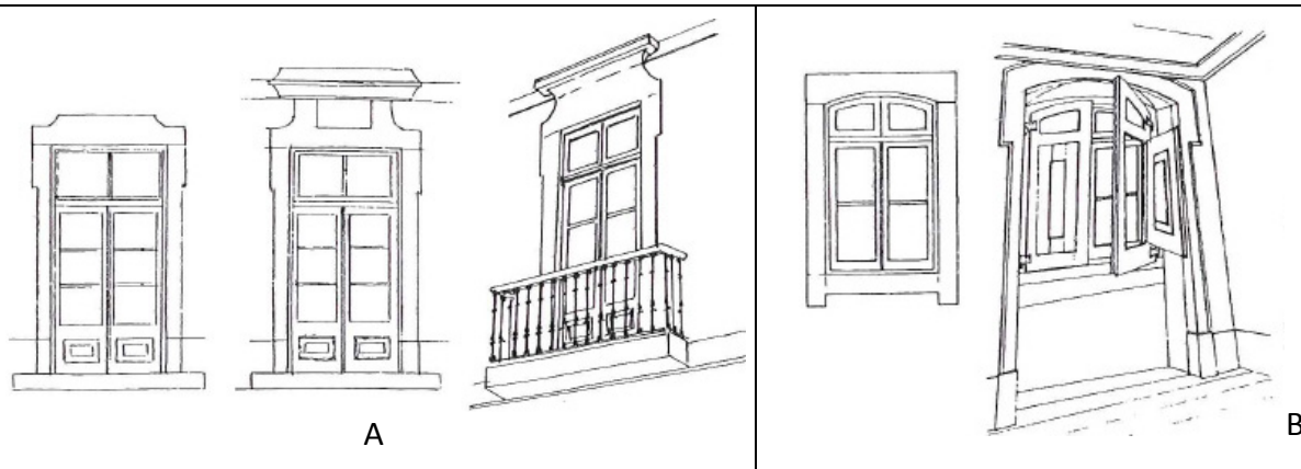
Figura 83: Disposição das janelas. (A) Janela de sacada sem frontão reto, (B) Janela de sacada com frontão reto (Adaptado de MASCARENHAS, 2005, p. 118).
