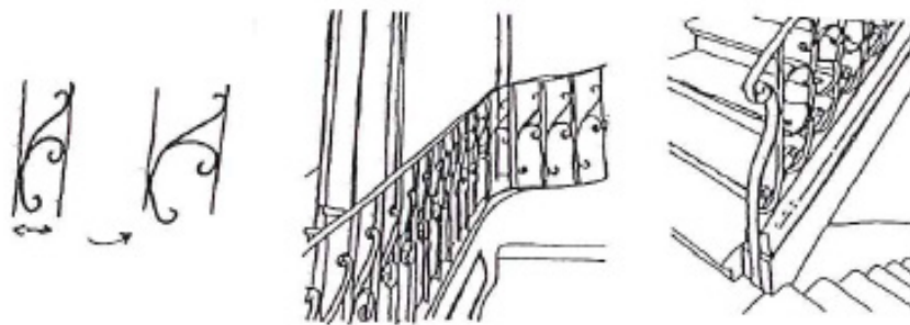
Figura 101: Ajuste de ferragens de balaústres (adaptado de MASCARENHAS, 2005, p. 188).
