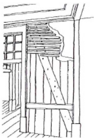
Figura 24: Paredes de tabique. (A) parede costaneira (Adaptado de MASCARENHAS, 2005, p. 93), (B) parede de tabique – Edifício em Alfama (Adaptado de MIRANDA, 2011, p. 36)
