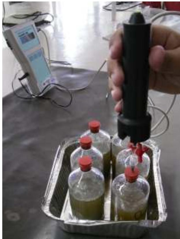
Figura 2.2 - Registro manual das pressões dos frascos usando-se um transdutor conectado a um amperímetro digital. Fonte: Arquivo Pessoal
