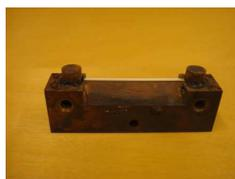
Figura 4.14: Célula onde estava posicionado o capilar. Essa célula permite a passagem de ar nos dois extremos.
