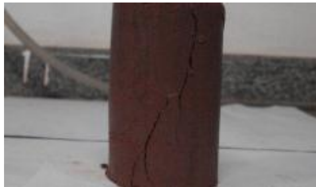
Figura 3.28 – Rompimento da amostra de solo puro do ensaio triaxial cíclico
