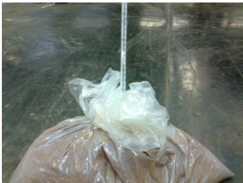
Figura 3.9 – Aumento da temperatura na preparação de amostra com cal virgem
