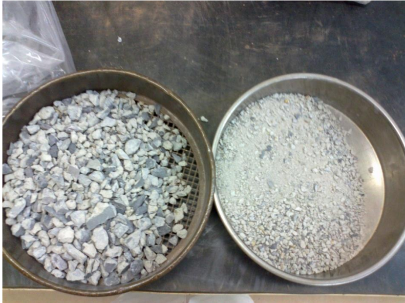
Figura 3.8 – À esquerda, grãos retidos na peneira #4; à direita os grãos passantes nesta peneira
