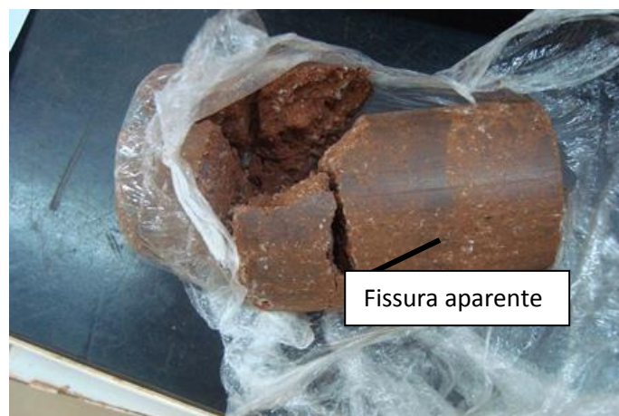
Figura 4.50 – Ruptura quando retirado do papel filme da amostra de solo + RCD
