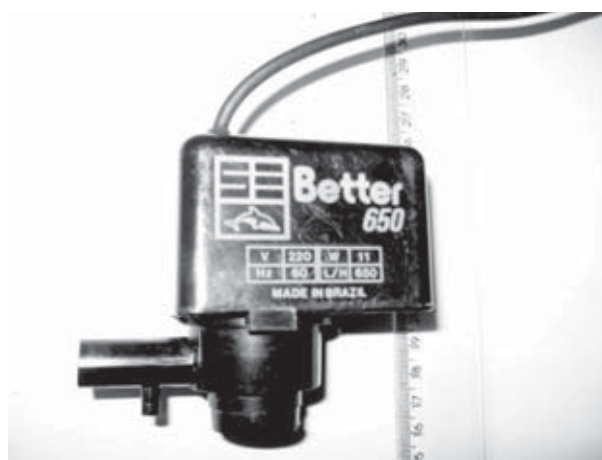
Figura 8.4: Bomba usada para realimentar o tanque reservatório.
