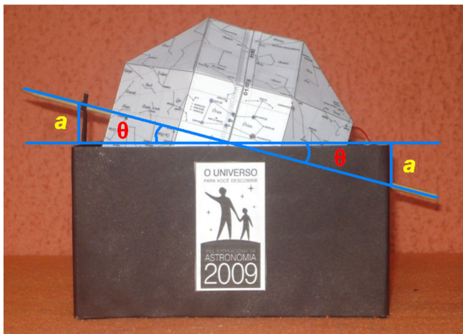
Figura 11: A inclinação do corpo principal do mini-planetário depende da latitude local. Na figura, \theta equivale, em graus, à latitude do local que se deseja obter a projeção. O tamanho do segmento a , em cm, para uma base de lateral 15 cm, é encontrado com a Expressão 1.
