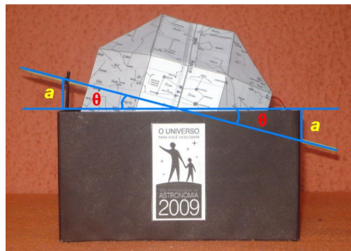
Figura 19: O ângulo de inclinação – \theta – equivale à latitude do local que se deseja obter a visualização do céu.
