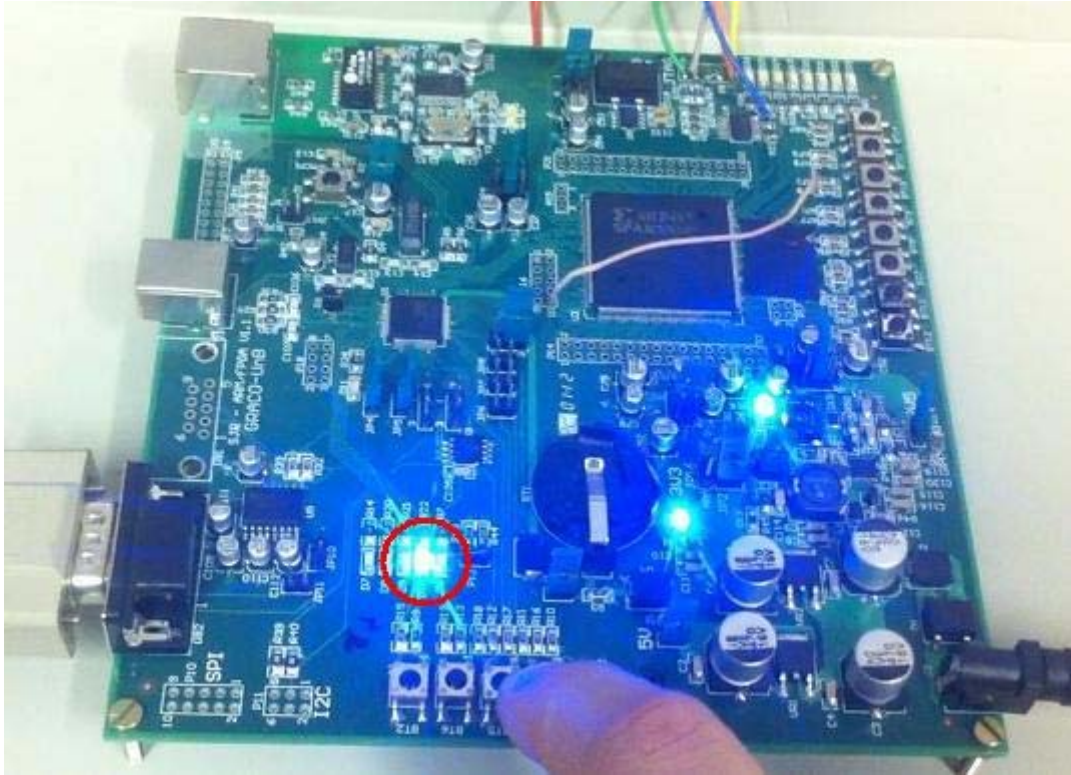
Figura 45 – Foto do teste de funcionamento do ARM .
