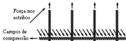
Figura 2.8 – Adaptação de Mörsch a treliça de Ritter (MÖRSCH, 1902).
