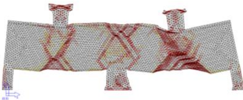
Figura 7. 20 – Deformada + Distribuição do dano a tração no passo 4 (15x).
