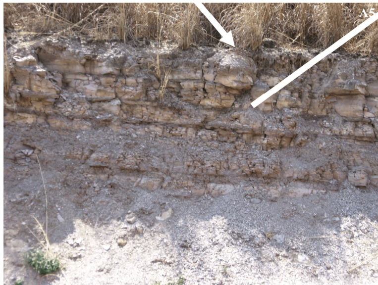
Figura IV-24: Foto A - Formação Corumbataí na BR – 158. Foto A5 – arenito com intercalações de lentes de arenito silicificado e material argiloso branco. Foto A6 – siltito macio com intercalações de camadas irregulares de material silicificado.
