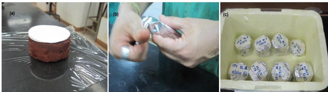
Figura 3.5 - Preparação dos corpos de prova: a) Papeis filtro e filme plástico, b) Envolvimento com filme de alumínio, c) Acondicionamento em caixa térmica
