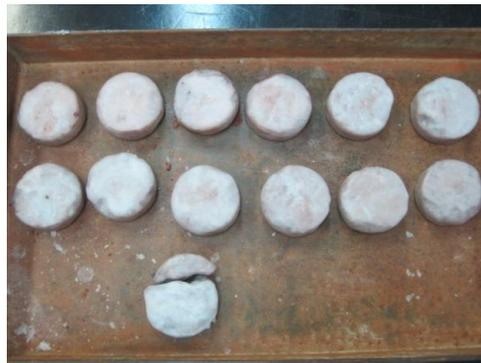
Figura 3.6 - Corpos de prova com parafina no ensaio da balança hidrostática
