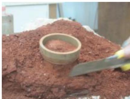
Figura 3.3 - Moldagem dos corpos de prova com cilindro de PVC
