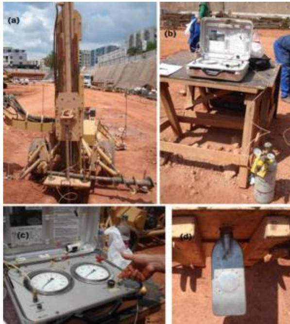
Figura 2.18 - Equipamento do ensaio: (a) Máquina da cravação (b) Conjunto do equipamento de ensaio (c) Caixa de controle (d) Lâmina dilatométrica
