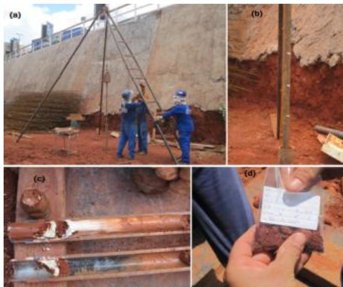
Figura 2.13 - Sequência do ensaio: (a) Tripé, (b) Marcação dos 45 cm, (c) Amostrador com amostra coletada, (d) Análise tátil visual
