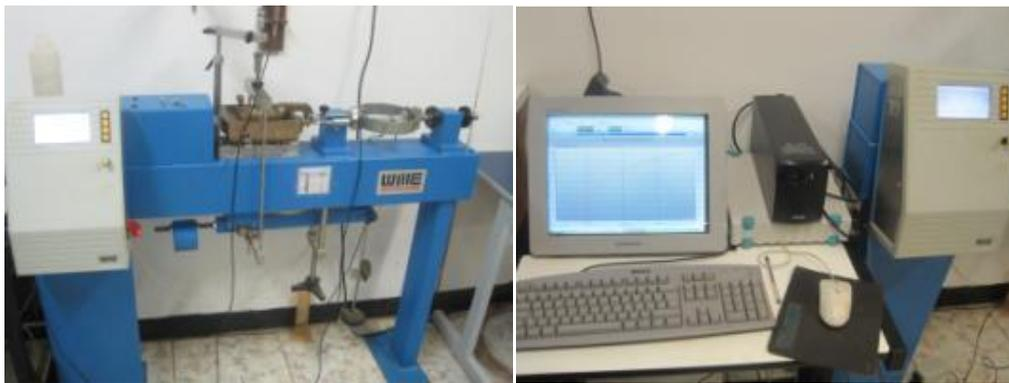
Figura 3.8 - Equipamento utilizado no ensaio: a) Máquina automatizada, b) Sistema computacional de aquisição de dados
