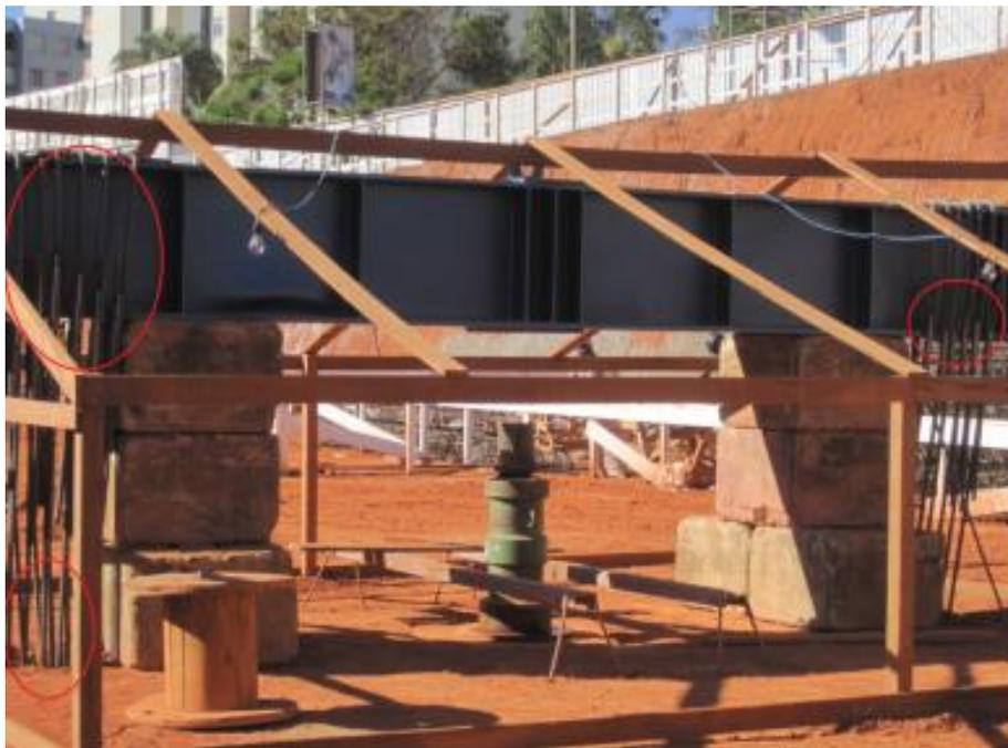
Figura 3.14 – Localização das ancoragens na montagem da prova de carga
