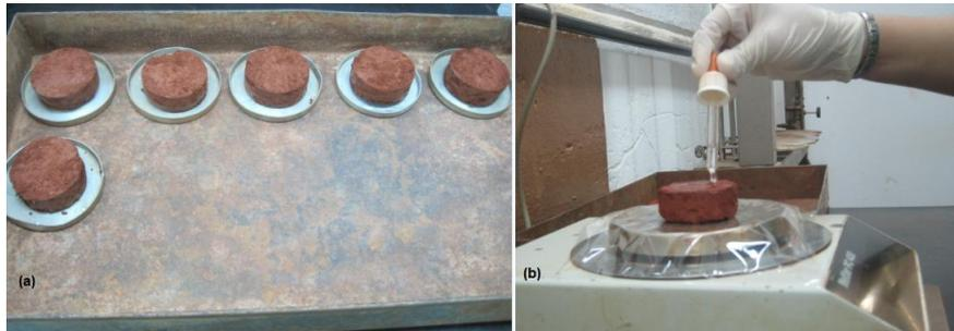
Figura 3.4 - Preparação dos corpos de prova para o ensaio: a) Secagem ao ar, b) Umedecimento por gotejamento
