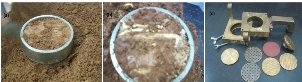
Figura 3.7 - Preparação para o ensaio: a,b) Moldagem, c) Caixa circular utilizada
