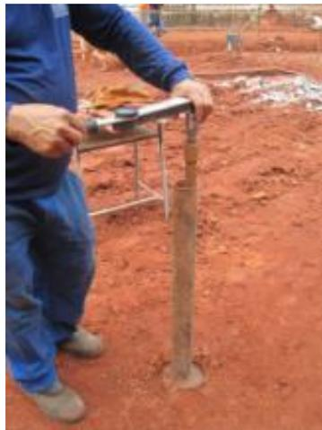
Figura 2.17 - Instalação do torquímetro
