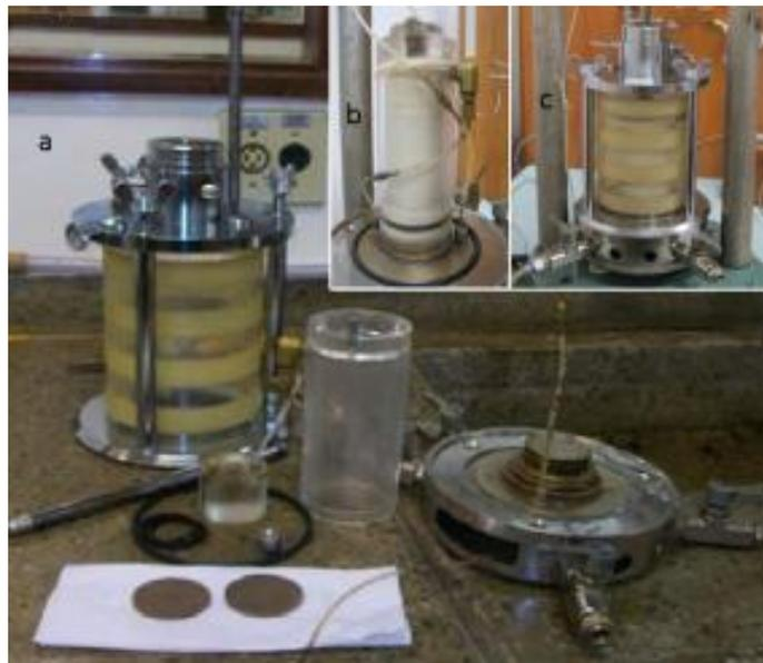
Figura 3.10 - Célula triaxial tipo  $k_0$ : a) Parte desmontada da célula, b) Célula interna, c) Célula montada (modificado - Aguiar, 2010)
