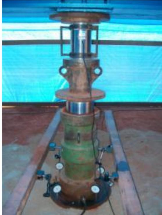
Figura 3.15 - Montagem do sistema de reação e dos extensômetros da prova de carga
