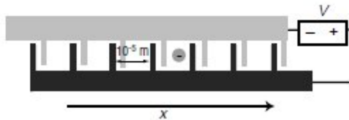
Fig. 5.5: Eletrodos intercalados que geram um potencial dente de serra - separador
