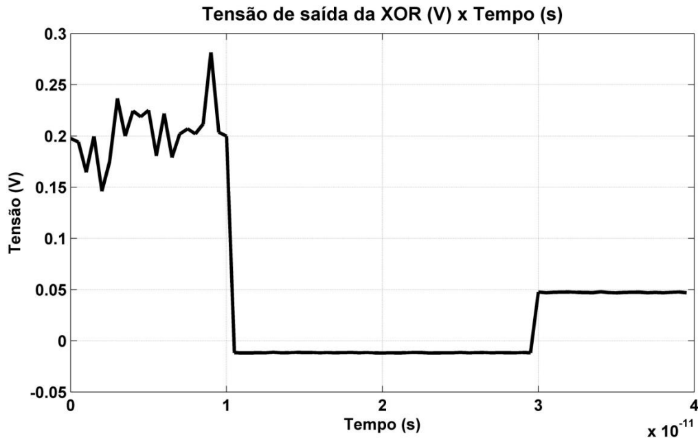
Figura 4.14. Tensões de saída da XOR - simulação no SIMON.
