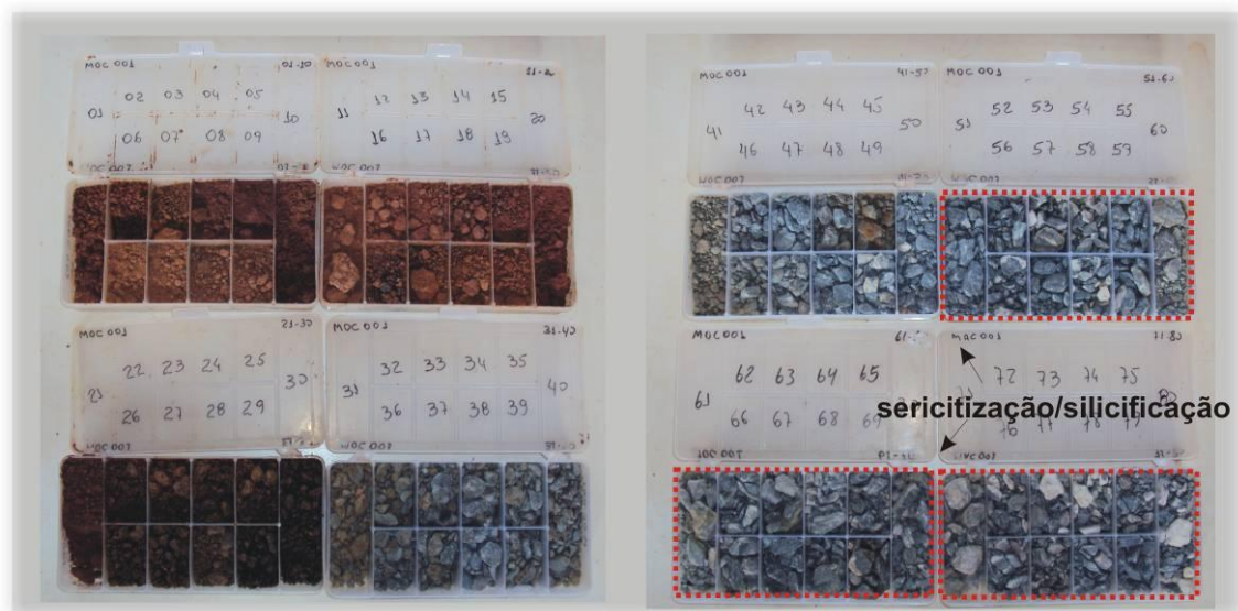
Figura 4.8 Chip de sondagem RC do alvo Manoel. Em destaque a intensa silicificação da encaixante máfica (Dados cedidos pela Troy/Reinarda Mineração)
