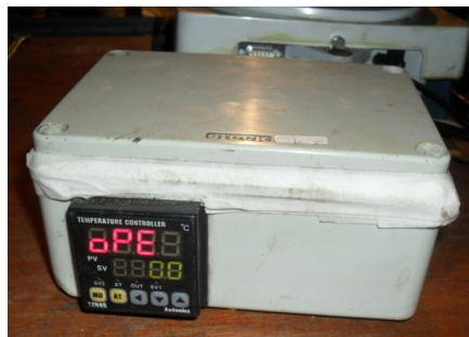
Figura C.10: Controlador de temperatura
