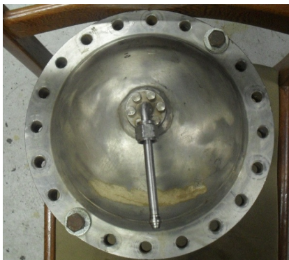
Figura B.1: Vista superior da tampa do reator
