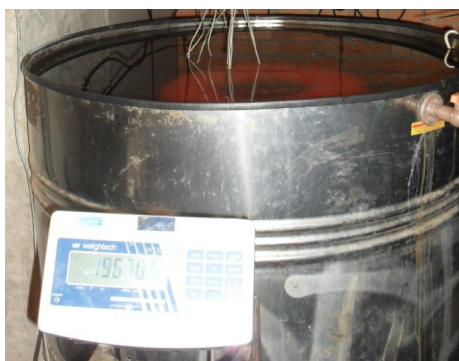
Figura C.7: Reservatório de água de 1000 L
