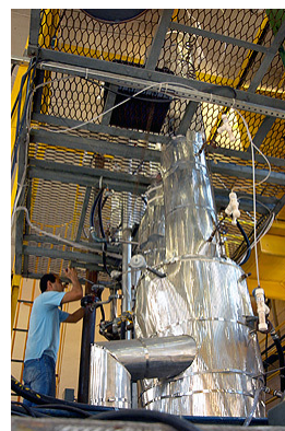
Figura A.4: Reator de Leito Fluidizado Circulante. Fonte: Filho, 2011
