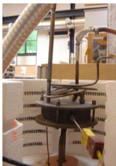
Figura A.13: Reator vortex Fonte: Almeida, 2008
