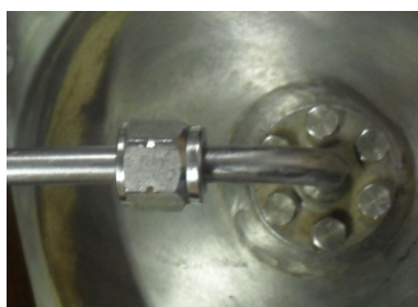
Figura B.7: Junção na tampa do reator
