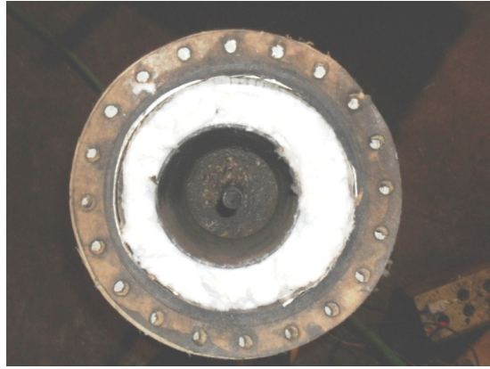
Figura 3.10: Isolamento térmico com lã de vidro
