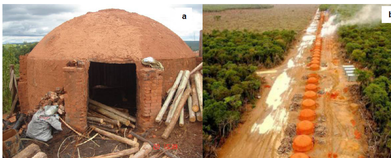
Figura 2.9: Forno rabo-quente a) Forno rabo-quente ou meia-laranja – b) Bateria de fornos rabo-quente. Fonte: Pimenta, 2007
