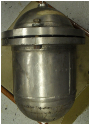
Figura B.4: Visão lateral do corpo do reator
