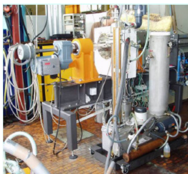
Figura A.11: Reator Ablativo da PyTec's Fonte: Gyftopoulou e Bridgwater, 2011
