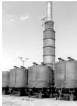
Figura 2.16: Forno metálico semicontínuo. Fonte: FAO, 1985
