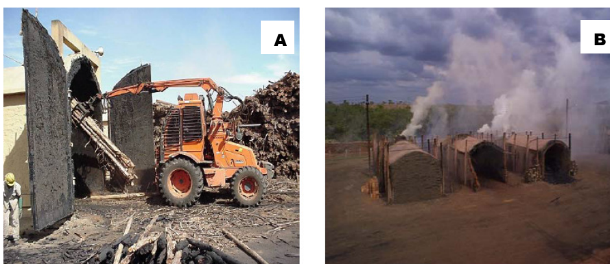
Figura 2.14: Forno V &M: a) Forno V & M sendo carregado – b) Forno V & M carbonizando. Fonte: Pimenta, 2007
