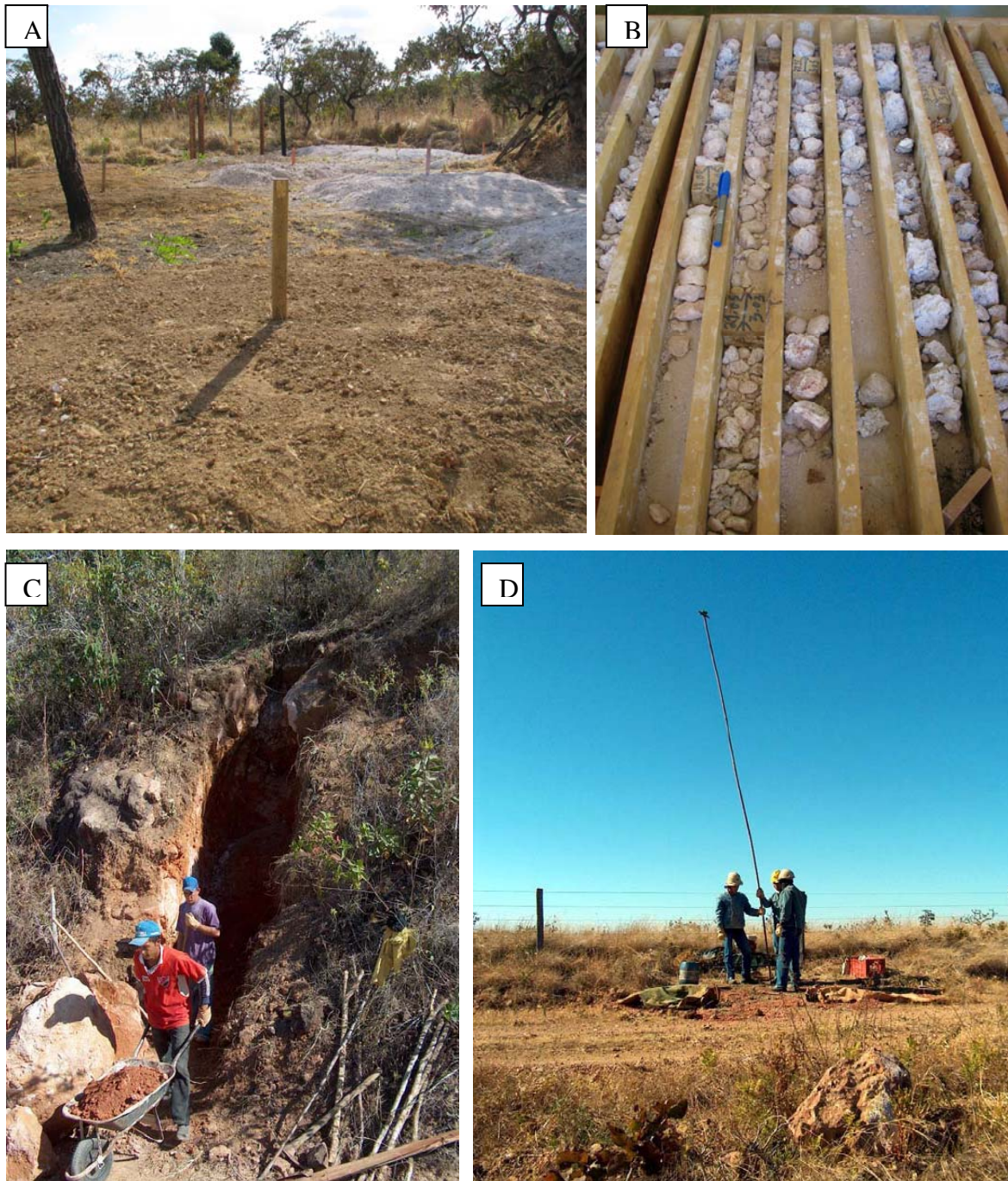
Figura 5.2. A: Pilha de material escavado em poços de pesquisa e individualizado a cada metro. B: Testemunho de sondagem rotativa a diamante, marcado pela baixa recuperação do material, principalmente dos níveis argilosos. C: (Foto Veiga, 2005) Escavação de bancada em barranco da estrada, para exposição do perfil de intemperismo e coleta de amostras. D: (Foto Veiga, 2005) Sondagem a trado motorizado executada em solo bauxítico no topo do espigão, recoberto por vegetação rala característica.
