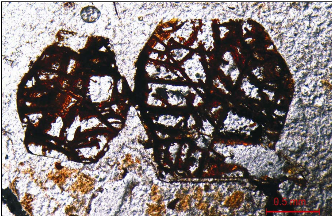
Figura 7.9. Pseudomorfos de granada, marcados pela cristalização de goethita ao longo dos planos de fissuras formando uma estrutura do tipo “ box-work ” e preenchidos por gibbsita.
