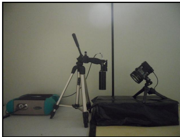
Figura 3.5. Sistema de aquisição de dados do espectrorradiômetro FieldSpec do Departamento de Geografia da Universidade de Brasília.
