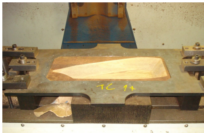
Figura 63: Prensa chapas com matriz negativa em madeira
