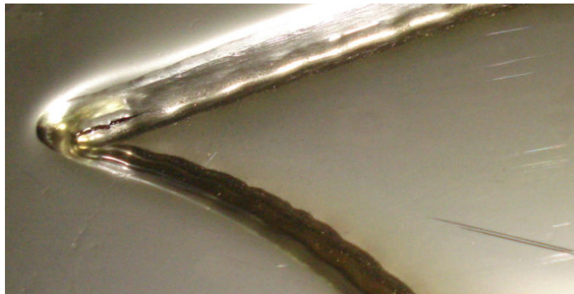
Figura 73: Detalhe do rompimento da chapa do nono teste.
