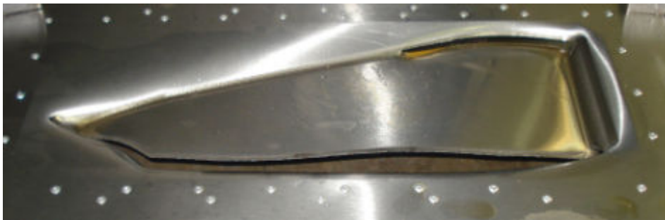
Figura 67: Rompimento da chapa do primeiro teste continuação
