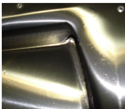
Figura 71: Rompimento da chapa do terceiro teste.
