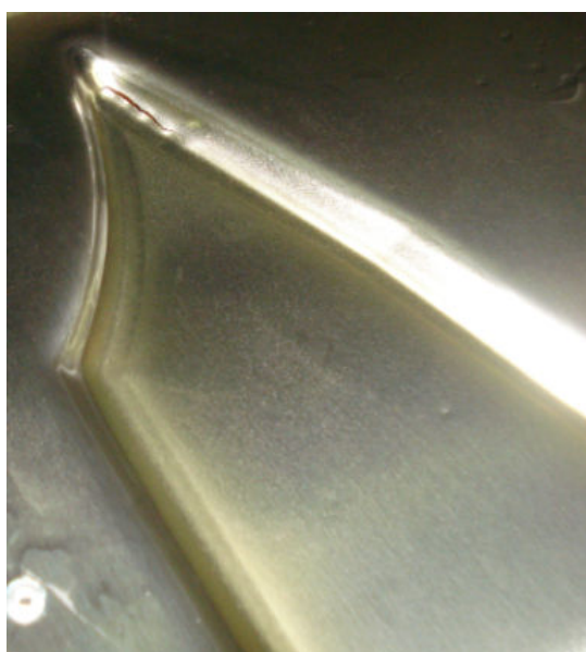
Figura 72: Rompimento da chapa do oitavo teste.
