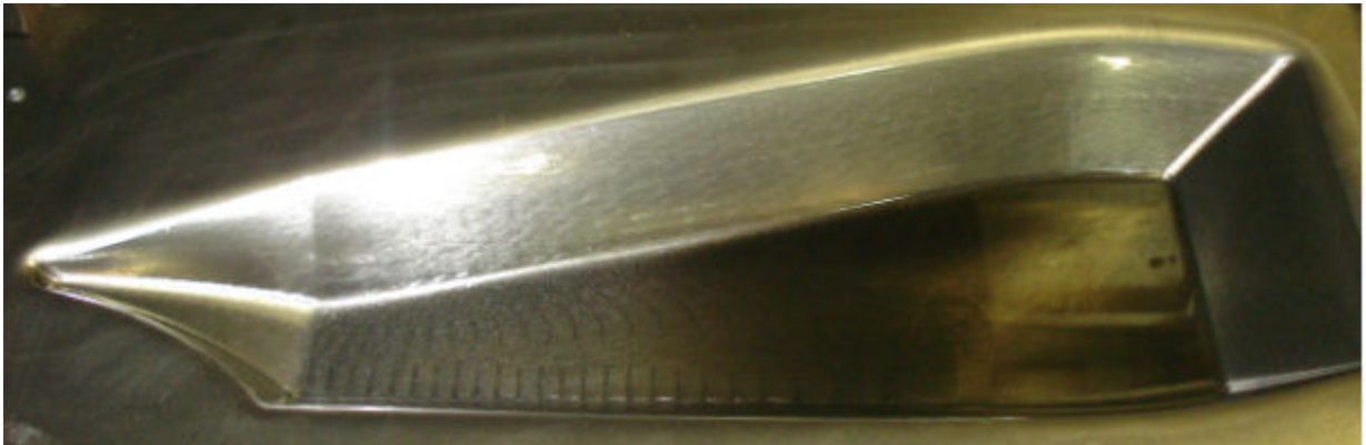
Figura 84: Chapa conformada com ferramenta diâmetro 10.5 mm.
