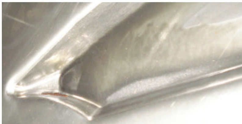
Figura 85: Chapa conformada com ferramenta de diâmetro de 14 mm.
