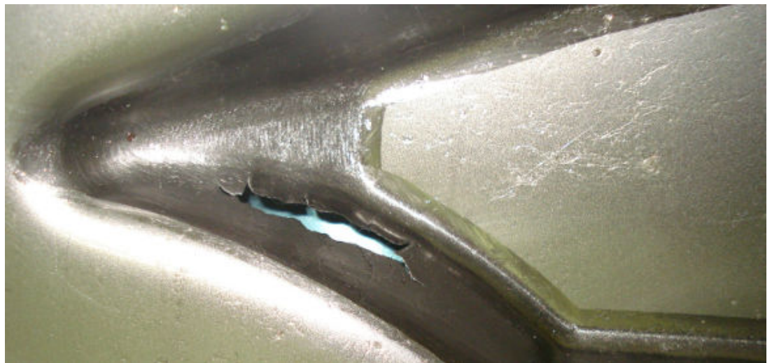
Figura 87: Rompimento tipo rasgo.
