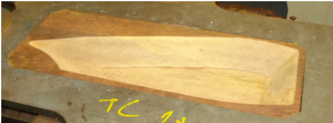
Figura 77: Usinagem da matriz dedicada.
