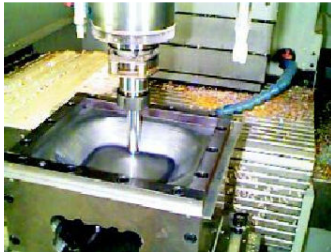
Figura 4: Estampagem incremental em um Centro de Usinagem (MCCLOUGHIN, 2005).
