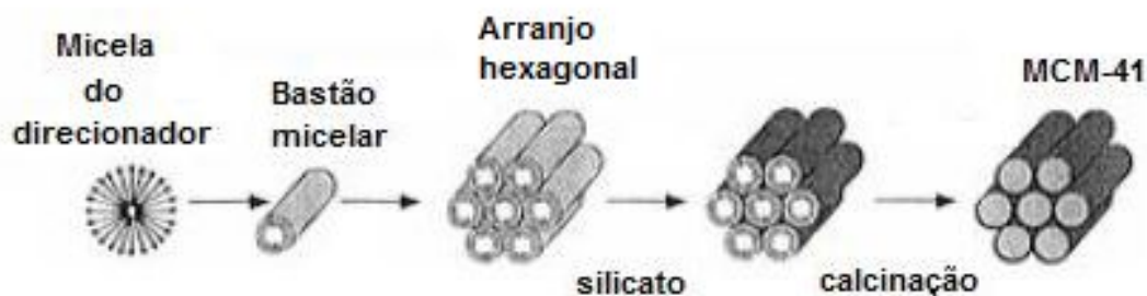
Figura 3. Mecanismo proposto originalmente para a síntese da MCM-41 [5,11].
